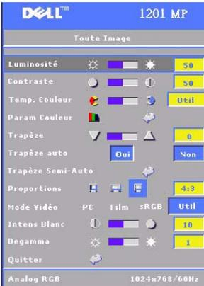
**LUMINOSITÉ** — Utilisez le bouton  $\ominus$  ou  $\oplus$  du panneau de contrôle ou le bouton  $\blacktriangleleft$  ou  $\blacktriangleright$  de la télécommande pour régler la luminosité de l'image.
