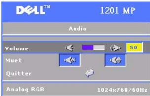
**VOLUME** — Appuyez sur le bouton  $\ominus$  du panneau de contrôle ou sur le bouton  $-$  de la télécommande pour baisser le volume et appuyez sur le bouton  $\oplus$  du panneau de contrôle ou sur le bouton  $+$  de la télécommande pour monter le volume.
