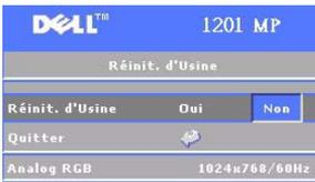
Sélectionnez **Oui** pour rétablir les réglages d'usine par défaut du projecteur. La réinitialisation affecte les paramètres Image d'ordinateur et Image vidéo.
